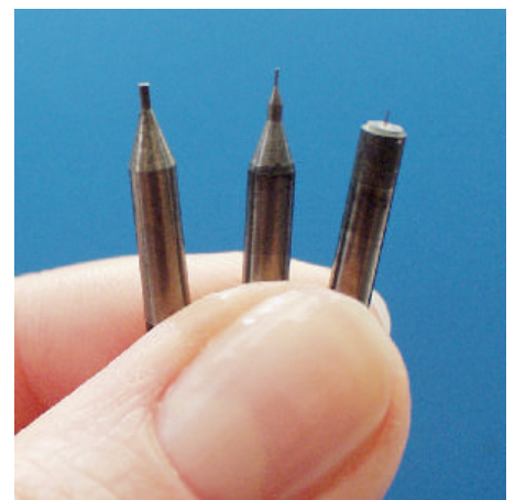
compeDIA®-Mikroschleifstifte, Durchmesser 0,6 mm, 0,15 mm und 0,07 mm.
